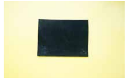
水砂紙 若有細微刮傷及割傷，可直接使用240~400#的水砂紙研磨清除。
